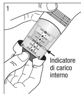
**Figura 1: regolazione del POWERbreathe**
