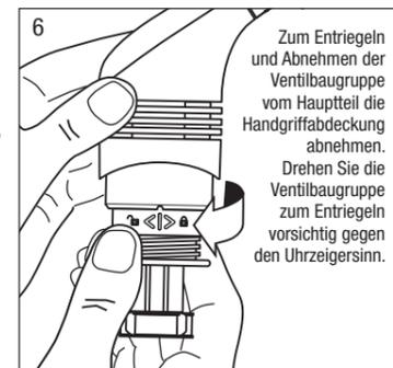
Zum Entriegeln und Abnehmen der Ventilbaugruppe vom Hauptteil die Handgriffabdeckung abnehmen. Drehen Sie die Ventilbaugruppe zum Entriegeln vorsichtig gegen den Uhrzeigersinn.
