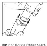
本体またはバルブ構造部を回転させないでくだ さい。図に示す位置決めピンが損傷する 恐れがあります。
