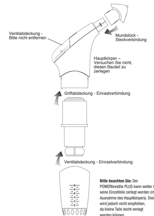
**Bitte beachten Sie:** Der POWERbreathe PLUS kann weiter in seine Einzelteile zerlegt werden (mit Ausnahme des Hauptkörpers). Dies wird jedoch nicht empfohlen, da kleine Teile leicht verlegt werden können.
