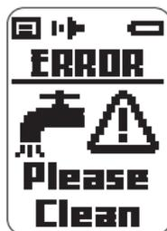
Se o cabeçote da válvula ficar entupido com saliva ou sujeira, a unidade do POWERbreathe não poderá funcionar corretamente e uma mensagem de erro será exibida. Se isso acontecer, siga as instruções de limpeza detalhadas na seção 11.1
