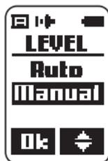
A configuração manual permite que você mesmo defina a carga de treinamento e ajuste essa carga manualmente conforme seus músculos respiratórios ficarem mais fortes ou se sentir necessidade, para manter a intensidade do treinamento. Alguns usuários preferem o maior controle da intensidade da carga que este método proporciona.
