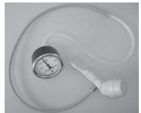
Figura 1 O Shaker (NCS, São Paulo, Brasil) é um equipamento portátil composto por um bocal e tampa perfurada, com cone e bola de aço inoxidável no interior. Foi acoplado, especificamente para o estudo, a um manovacuômetro.
